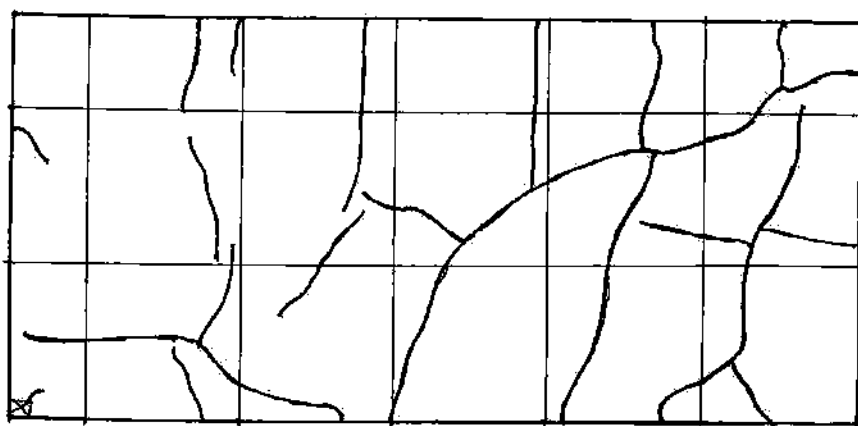
FIGUR 4. Sprickbildning i de första provväggarna.
